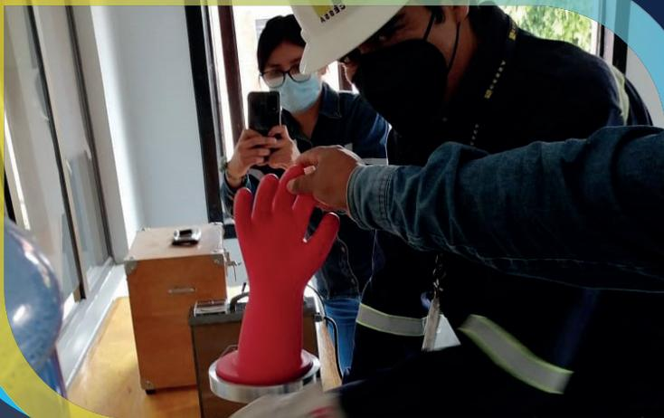
Inspecciones, pruebas y testeo de guantes dieléctricos, clase III, para trabajos en redes eléctricas.
