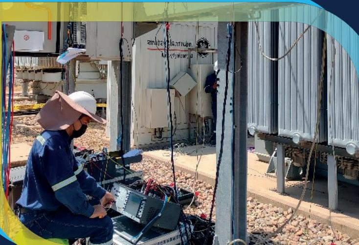
Mantenimiento preventivo en Subestación Aranjuez, con la ejecución de pruebas eléctricas a transformador de potencia T10, y equipos de patio asociados, transformadores de voltaje, transformadores de corriente, seccionadores, pararrayos e interruptores de potencia con personal y equipamiento propio.
